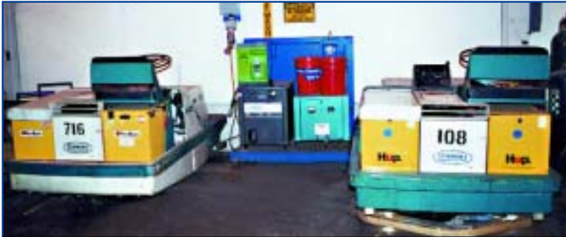
View of TENANT Floor Sweeper, Mdl. 240EH & TENANT Power Scrubber, Mdl. 540E
