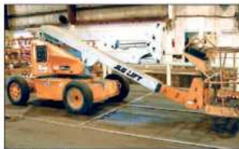
JLG BOOM LIFT
