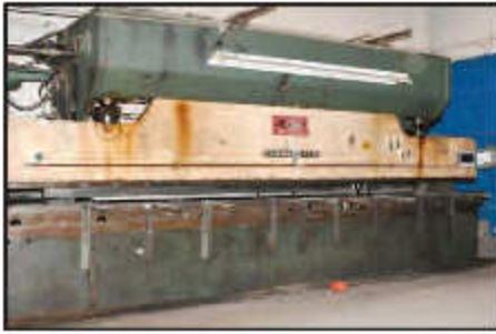
90 Ton x 20' Chicago Dreis & Krump CNC Press Brakes
