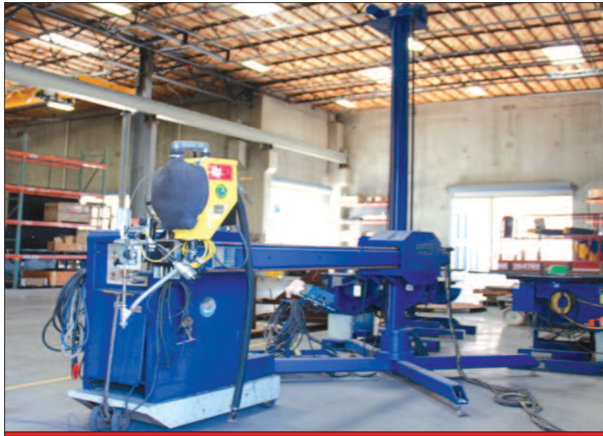
PrestonEastin SubArc Welding Manipulator
