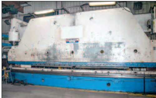
600-Ton x 30' Cincinnati CNC Hyd. Press Brake
