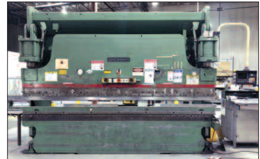
230-Ton x 14' Cincinnati CNC 2-Axis Hyd. Press
